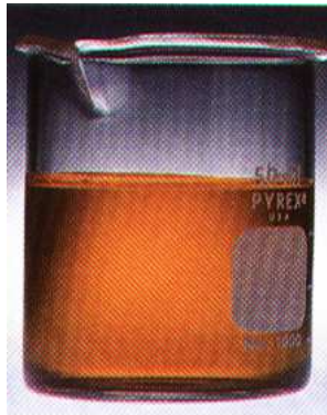
สีผสม สีส้ม สารละลาย จะต้องมี pH 4.4 – 6.3
